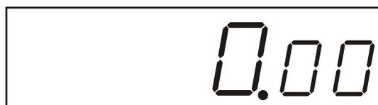
В зависимости от установленной цены счётного импульса на индикатор выводятся сотые доли литра (при цене счётного импульса 0.01л, 0.02л или 0.05л), десятые доли литра (0.1л, 0.5л) или только целые литры (1л, 5л и 10л).
